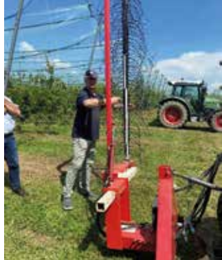
Outil Darwin, permettant l'éclaircissage mécanique des fleurs de pommier
