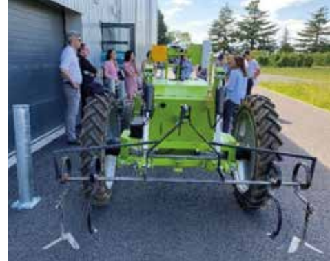
Robot e-Tract autonome pour le désherbage mécanique
